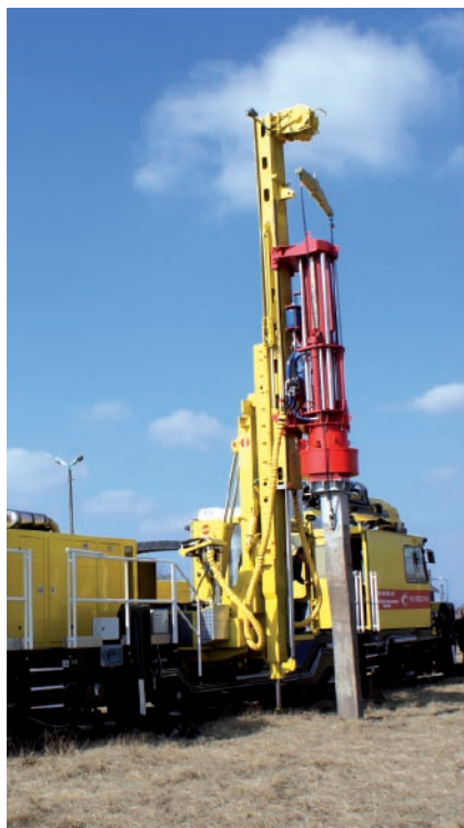
Kafar kolejowy typ KK3000H zabudowany na nisko-podwoziowej platformie kolejowej
